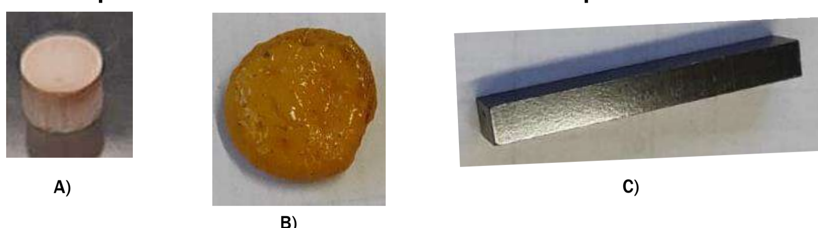
Figura 2: A) Resina pura antes da cura. B) Resina pura após a cura. C) Aspecto da amostra após a cura. Fonte: Elaborado pelo autor.
